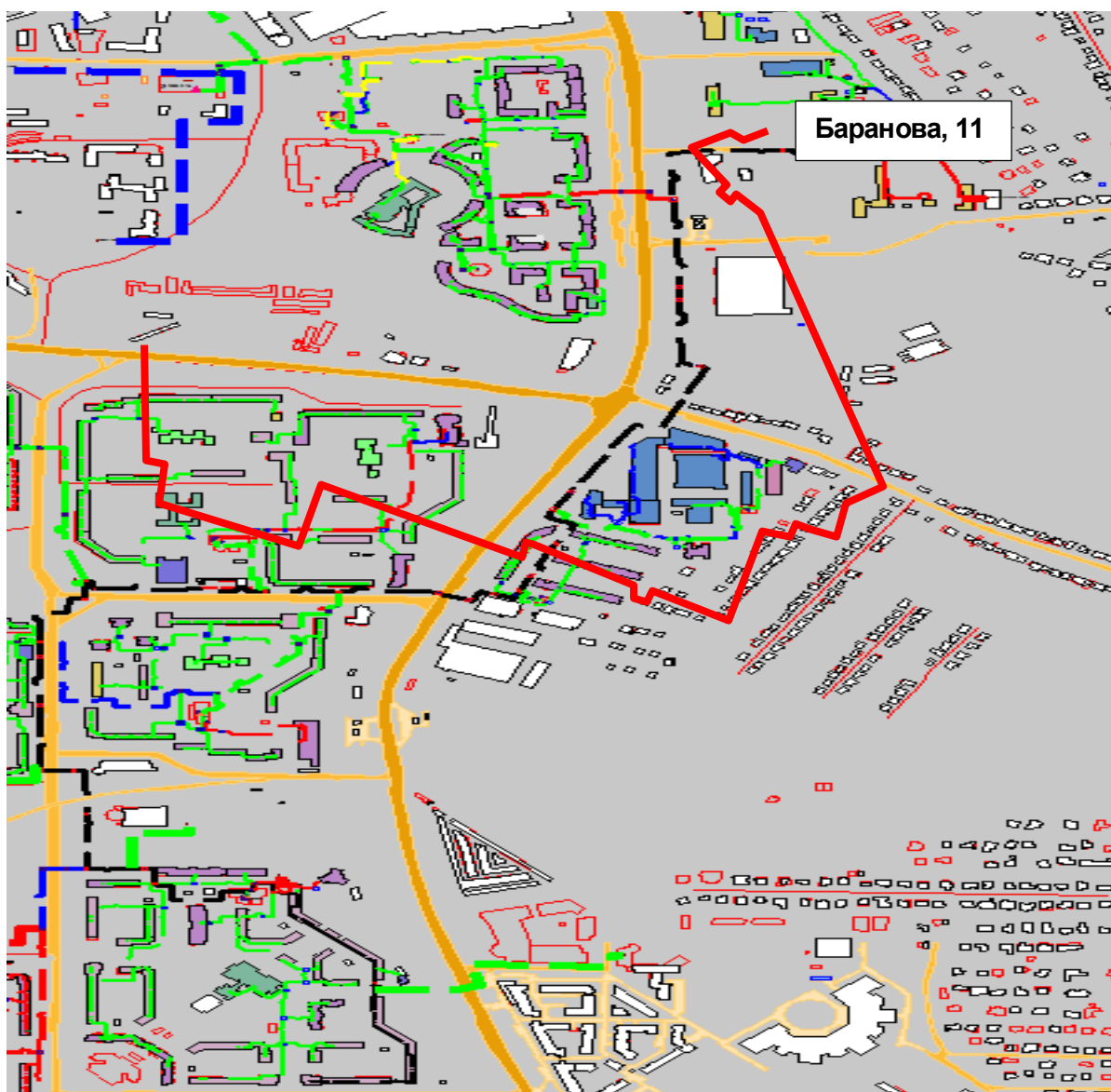
Рисунок 2.25 – Результат гидравлического расчета - расчетный путь теплоносителя от котельной ул. Родионова, 1946 до ПТ-Богдан.1 пр.
