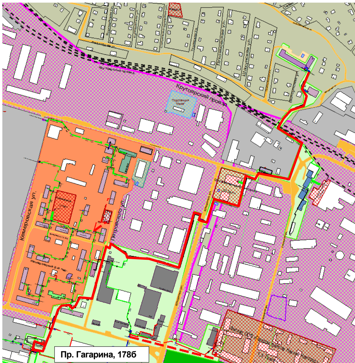
Рисунок 1.63 – Результат гидравлического расчета - расчетный путь теплоносителя от котельной пр. Гагарина, 1786 до ЦТП-706
